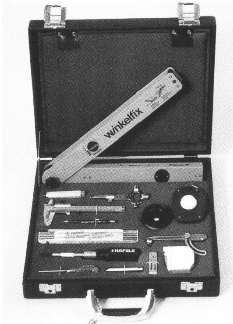
oben: Schmiege kombiniert mit Wasserwaage und Laser links: diverse Werkzeuge für die Massaufnahme
