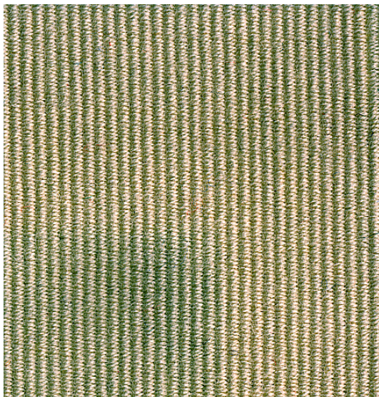
◁ Texilmuster Kettrips. Gut zu erkennen ist die Rippenbildung. Diese verläuft längs bezogen zur Stofflänge.
